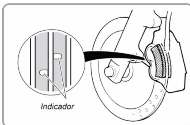
Os indicadores de desgaste das pastilhas de travão permitem verificar o desgaste sem desmontar o travão. Se o indicador quase tocar no disco do travão, entre em contacto com o seu concessionário para fazer a troca das pastilhas.
