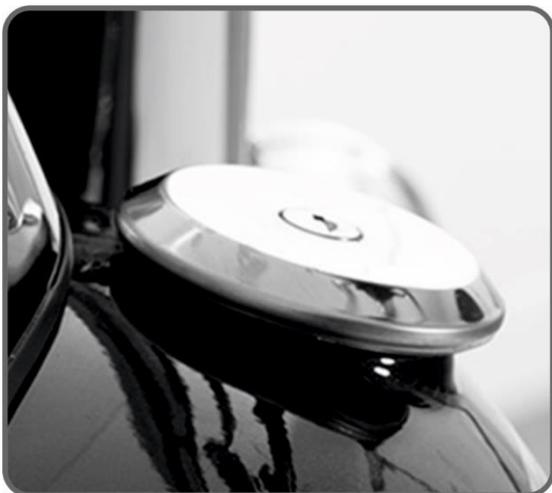
A tampa de combustível está localizada na parte superior do veículo e necessita de chave para ser aberta.
