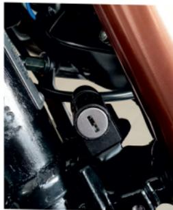
El bloqueo de la dirección está alojado en la parte derecha del árbol de dirección. Ruede al manillar totalmente hacia la izquierda, introduzca la llave, empuje y ruede en el sentido de las agujas del reloj hasta bloquear. Cuando el manillar queda bloqueado puede retirar la llave.
