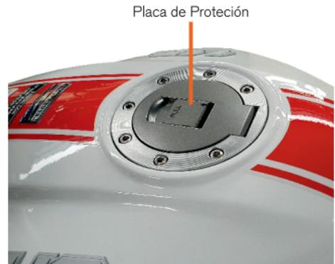
**ADVERTENCIA:** El cierre del depósito puede aumentar ligeramente la presión de aire en el interior, por lo que es normal que al abrir, escuche un ruido de salida de aire.
